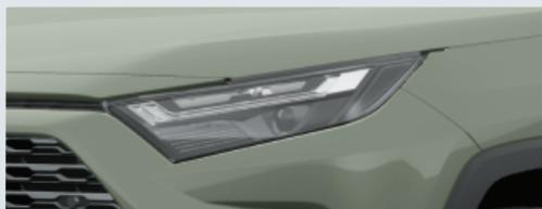
FAROS DELANTEROS BI-LED CON NIVELACIÓN AUTOMÁTICA EN ALTIMETRIA.
