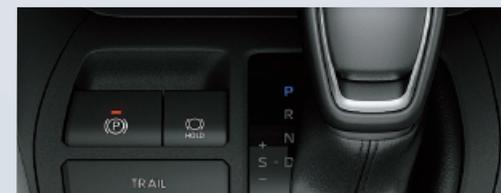
FRENO DE ESTACIONAMIENTO ELÉCTRICO CON FUNCIÓN "AUTO-HOLD".
